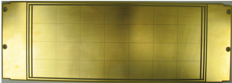
FIG. 1. The Micromegas Anode.
